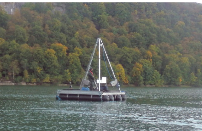
Lac de Chalain : forage profond à partir d'une barge, octobre 2015. © Hervé Richard.
