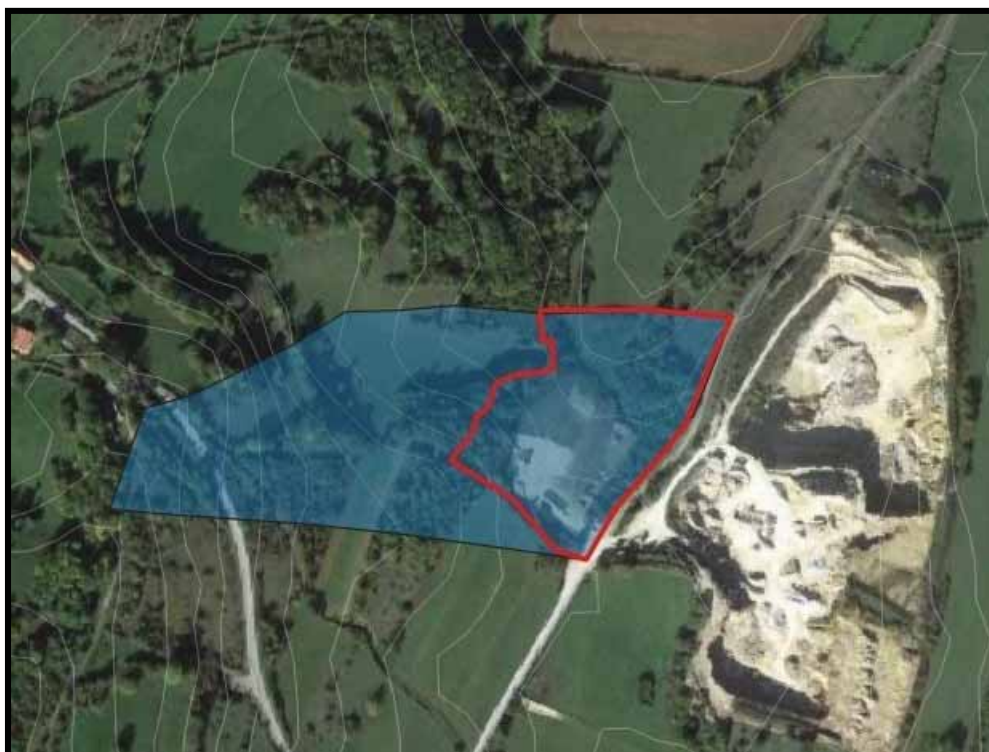
Bassin versant intercepté par le projet
