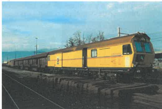
Train meuleur de rails (Scheuchzer S.A.)
