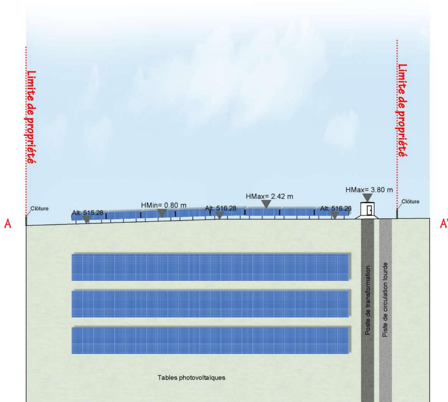
COUPE AA' : OUEST/EST DES PANNEAUX PHOTOVOLTAIQUES - échelle 1/500e
