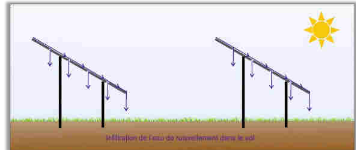
Figure 117 : Effet des panneaux solaire sur l'écoulement des eaux pluviales – Source : Sciences Environnement
